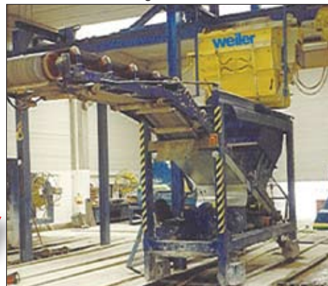
Alimentador de hormigón concrete feeder
